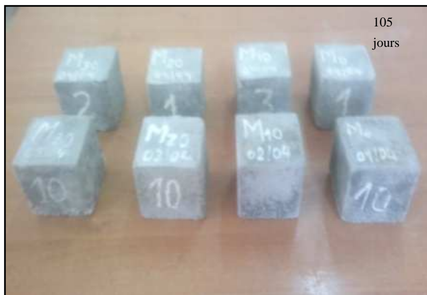
Fig.5. Etat des éprouvettes M0, M10, M20 et M30 (de droite à gauche) dans 5 % \text{Na}_2\text{SO}_4 comparées à celle exposées dans l'eau (en arrière plan).
